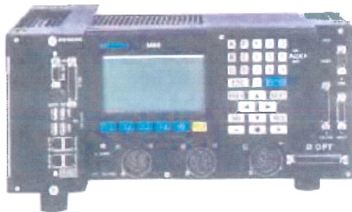
Siemens M62 controller running SEPAC® local controller software
